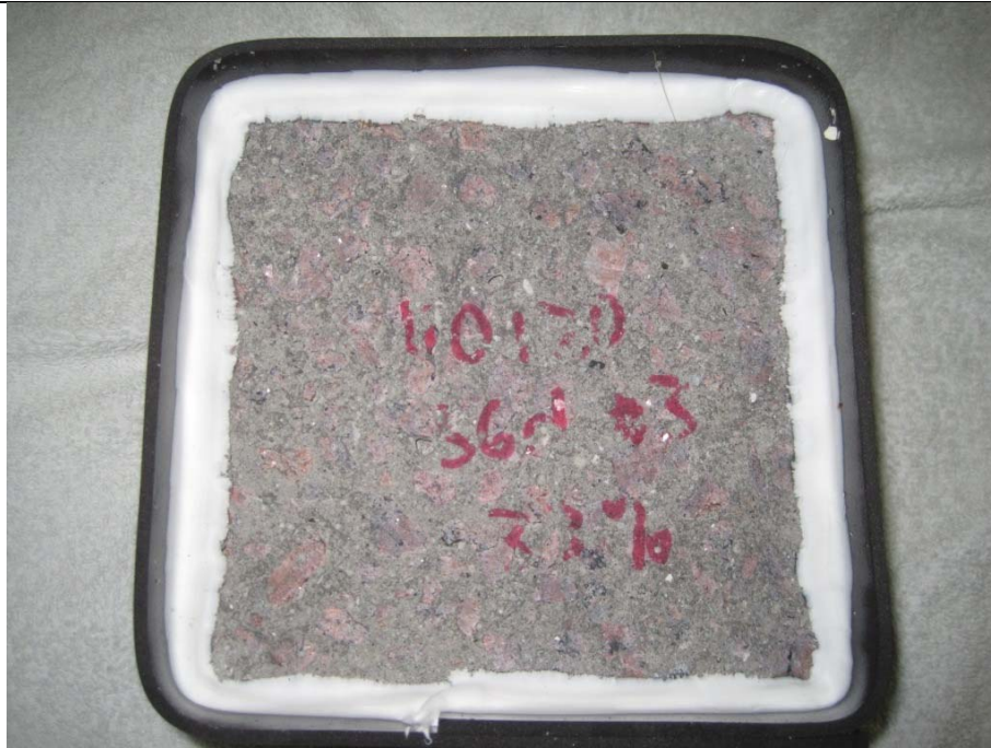
Prov 3. Total ackumulerad avskalning efter 112 fryscyklar= 0,117 \text{ kg/m}^2 .
