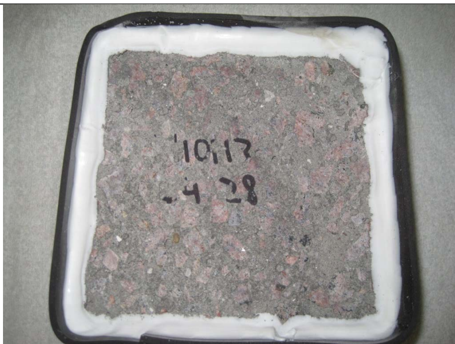
Prov 4. Total ackumulerad avskalning efter 112 fryscyklar= 0,202 \text{ kg/m}^2 .
