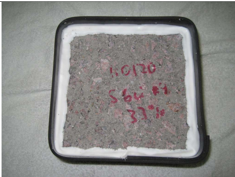
Prov 4. Total ackumulerad avskalning efter 112 fryscyklar= 0,082 \text{ kg/m}^2 .
