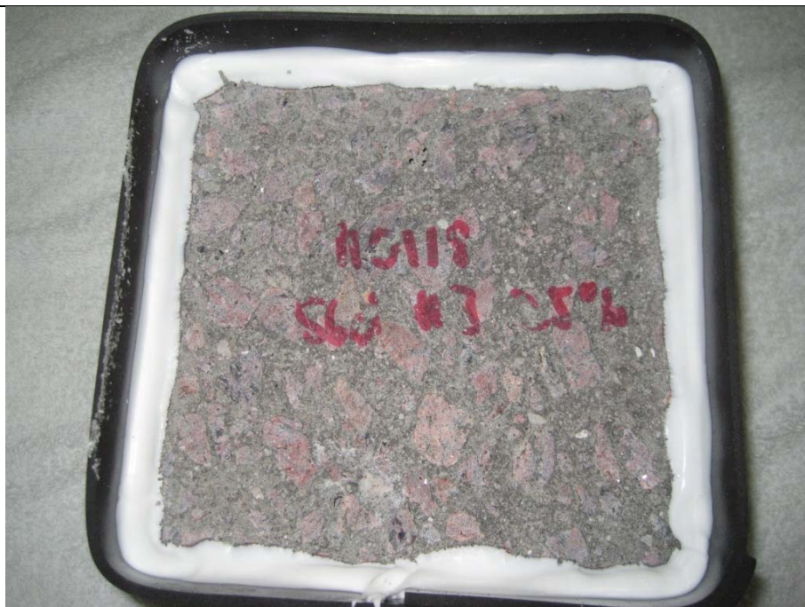
Prov 3. Total ackumulerad avskalning efter 112 fryscyklar= 0,093 \text{ kg/m}^2 .
