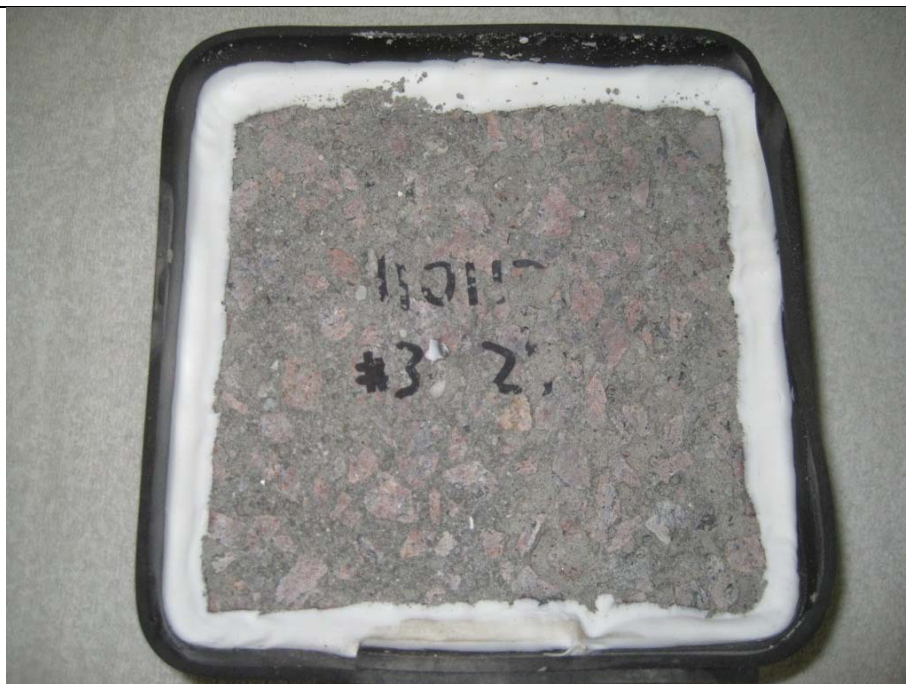
Prov 3. Total ackumulerad avskalning efter 112 fryscyklar= 0,307 \text{ kg/m}^2 .
